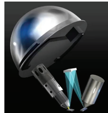
走査型マイクロフォーカスX線源の模式図
