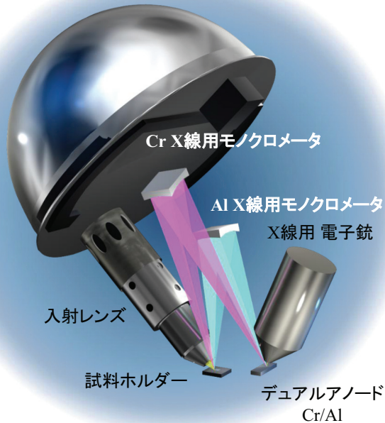
走査型デュアルモノクロX線源の模式図
